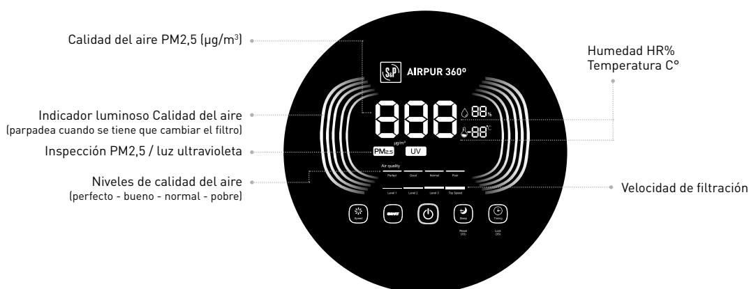
**ON/OFF:** Cuando el aparato está conectado a la red, el pulsador ON/OFF se ilumina de color rojo y permanece en modo de espera. Pulsando ON/OFF el purificador de aire se pone en marcha por defecto en **MODO SMART**.
